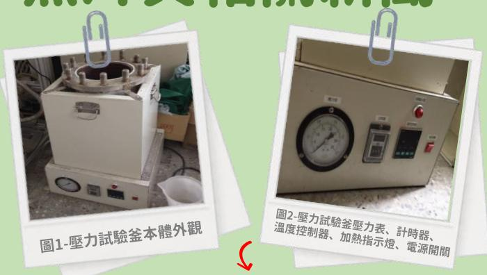
壓力表刻度上應明顯標示允許的最大壓力。
