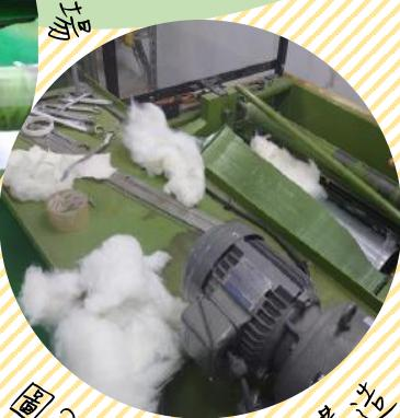
圖2-搖屏滾輪構造
